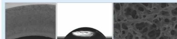
膜丝断面全貌 亲水性的膜表面 海绵状多孔支撑层（放大1万倍）
